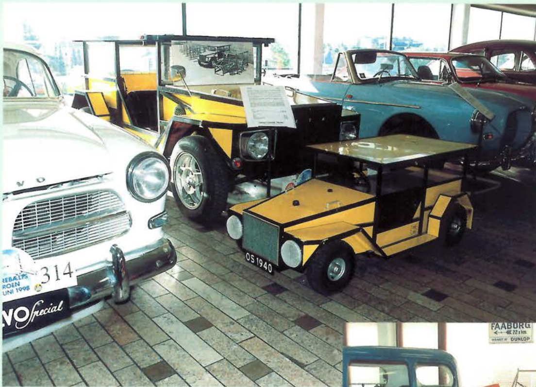
Wolseley Hornet 1932 med Swallow roadster karrosseri. 1.271 cc med overliggende knastaksel. Swallow byggede karrosserier og motorecykelsidevogne inden fabrikken begyndte at lave chassiser selv. Det som blev til Jaguar.
