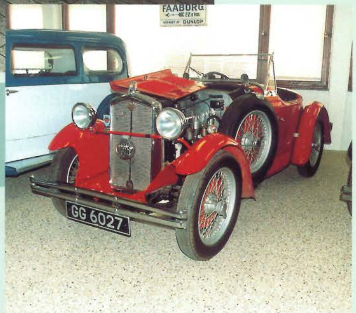
Wolseley Hornet 1932 med Swallow roadster karrosseri. 1.271 cc med overliggende knastaksel. Swallow byggede karrosserier og motorecykelsidevogne inden fabrikken begyndte at lave chassiser selv. Det som blev til Jaguar.
