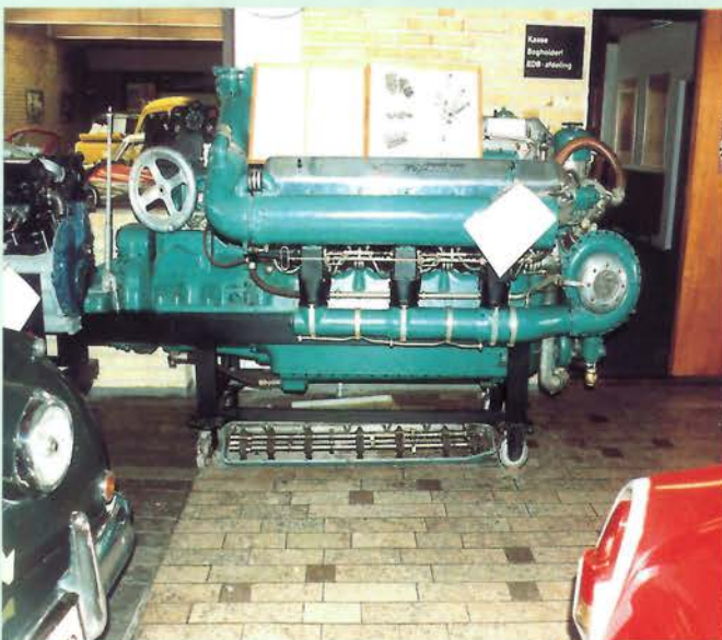
Isotta Fraschini motortorpedobådmotor på 18 cylindre og et slagvolumen på 57 liter fra 1923. Den ydede 1500 hk. ved bare 2000 o/m.
