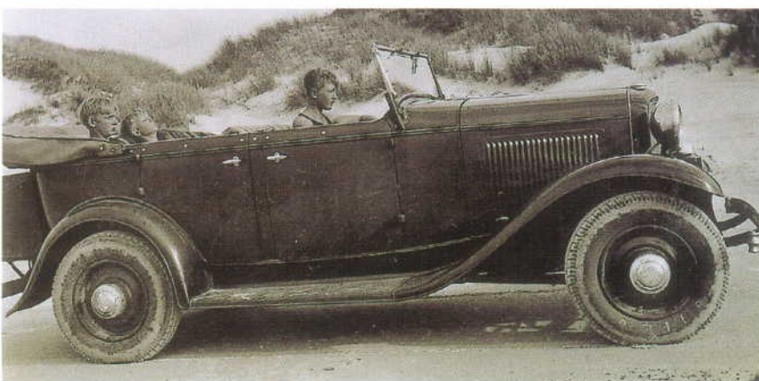
Et vue set fra siden, bemærk de store ballondæk, ellers kunne man ikke køre i sandet med vognen. En søn af værkstedet der monterede disse hjul i 1933 lever stadig på Anholt den dag i dag i en alder af 86 år...
