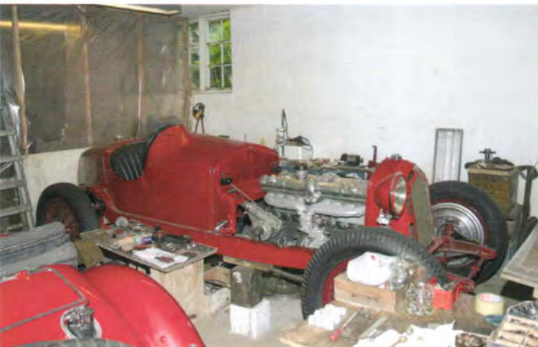
Monza – den ægte vare. Monza'ens motor er 8-cylindret og har kompressoren på siden.
