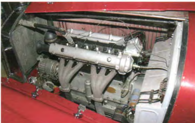
Den lille rødes motor. 5 hovedlejer, Rootes kompressoren sidder forrest.
