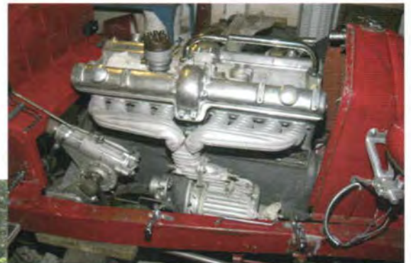
Monza – den ægte vare. Monza'ens motor er 8-cylindret og har kompressoren på siden.
