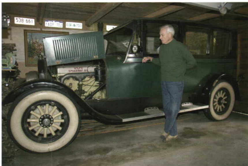
Niels Otto Jensen fandt sin Stutz 1925 i USA i 1978. 6-personers sedan med klapsæder men ikke adskillelse. Speedway Six motoren er topventilet og på 4.2 liter med 80 hk.
