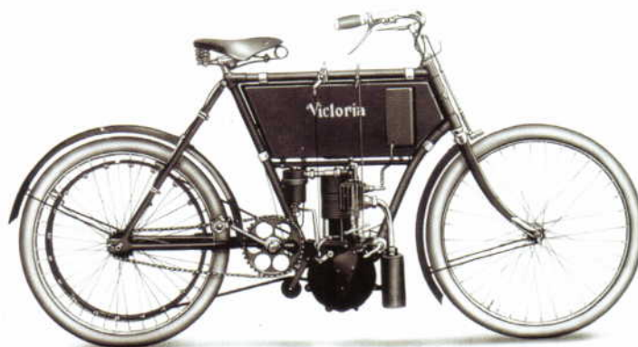
1901 das erste VICTORIA-Motorrad • 1½ PS Motor • 40 km st.
