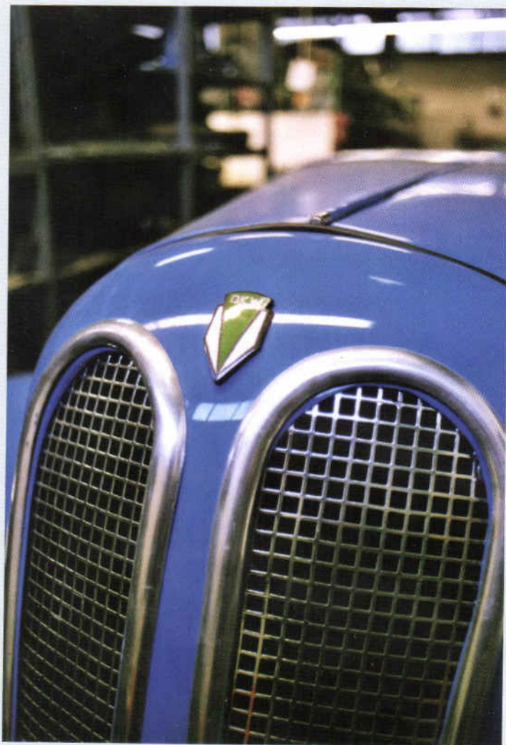
BMW? Nej: Karrosserifabrikken JHLE byggede specialkarosserier til bl.a. BMW Dixi og DKW og i dette tilfælde er BMW's karakteristiske 'nyrer' havnet under et DKW kølermærke. De tidlige BMW bilmodeller havde slet ikke det todelte kølegitter, der hænger ved den dag i dag, det fremstod af samarbejdet med JHLE.
