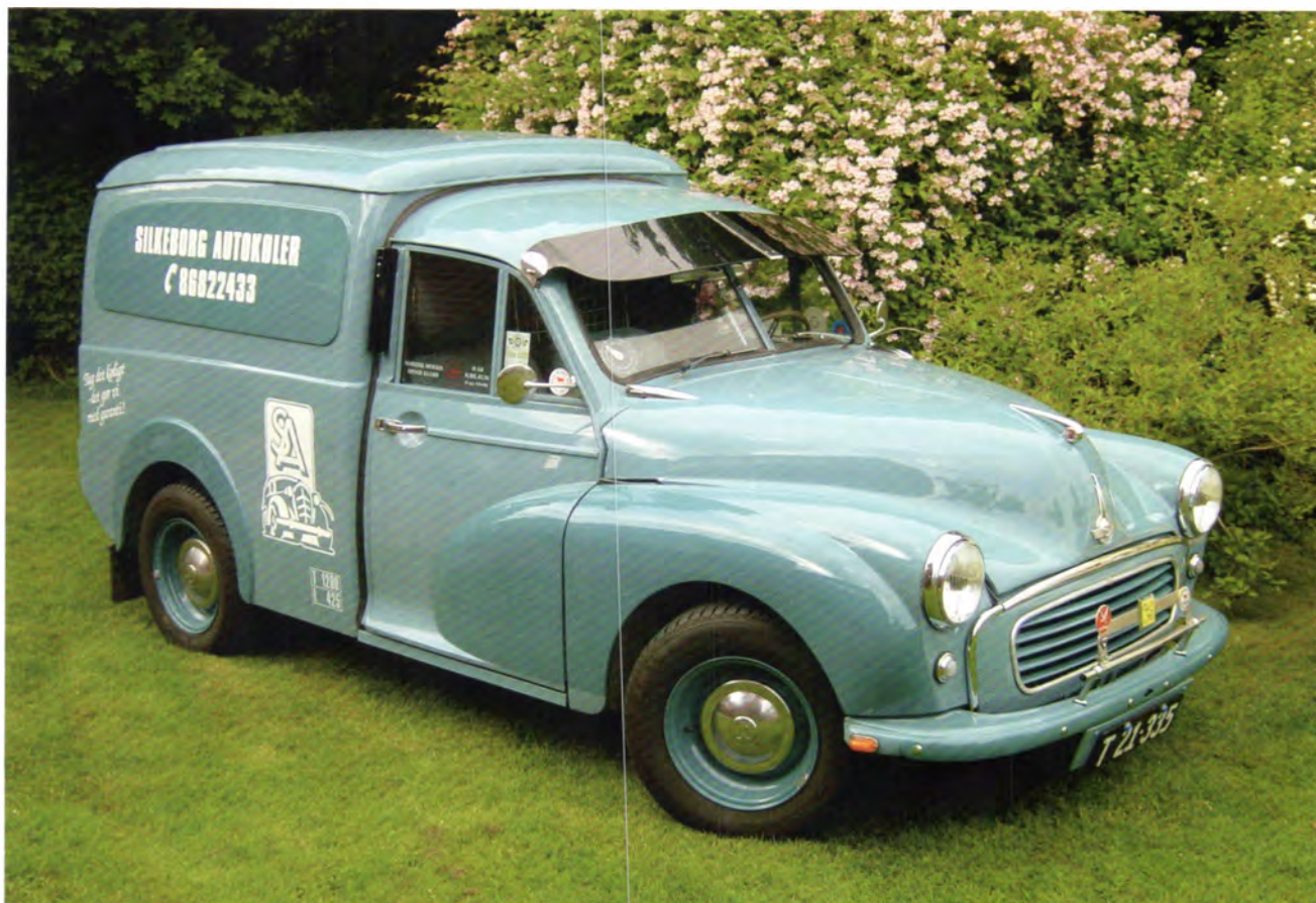
Lukket varevogn fra 1956. Fronten havde da fået sit endelige udseende, men midtersprossen i vindspejlet var der endnu.
