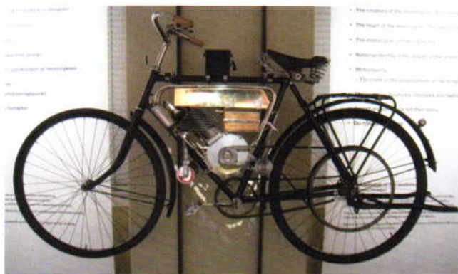
Motosacoche, dvs. motoren i tasken, 250 ccm, 1906. Schweiz. Rendyrket fornuftsbetonet konstruktionsæstetik, 1 motor + 1 cykel = 1 motorcykel. Man tager 'motoren i tasken' spænder motoren på cykelstellet og påsætter drivvrem. Enklere kan det ikke gøres. Solgtes herhjemme også under navnet E.L.G. Findes på Danmarks Tekniske Museum.
