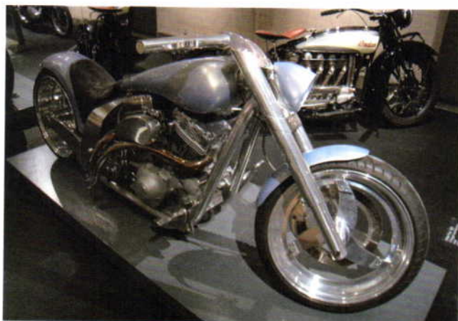
Det er ganske vist en designudstilling, men motorcyklen er også dansk håndarbejde. Stig Jensen Design, Innovator, opboret Harley-Davidson motor på 1420 ccm, 2008. Bagved en Indian Four 1928, også en dansk ombygning, ved Mads Bartholin Johnsen. Med motor fra en NSU Prinz 1000 bil og Nimbus gearkasse
