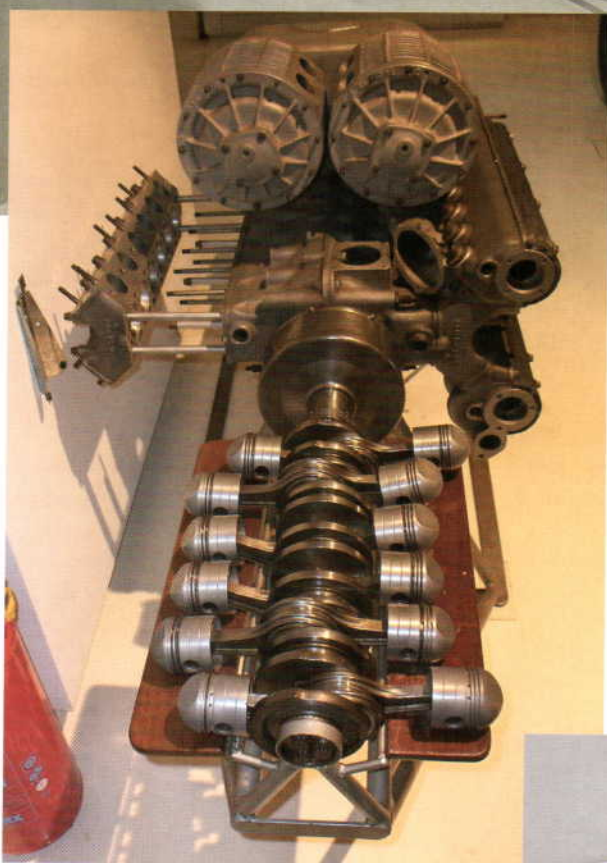
En sjældenhed er denne Cisitalia 360 racerbil fra 1946 fra Ferry Porsches tegnebræt. 1,5 liters, 12-cylindret, vandkølet boxermotor med kompressor, 385 hk. Til Porsche- og VW-entusiaster: bemærk forhjulsophængen!
