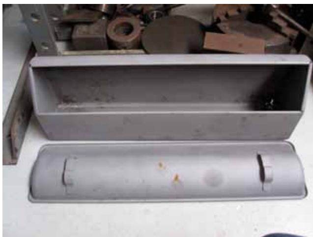
Bilen set fra højre. Læg mærke til de to kasselåg med håndtag i sideskørterne. Der er tilsvarende 2 kasser med låg på venstre side. En sandblæst kasse ses her. Den er klar til reparation og lakering.
