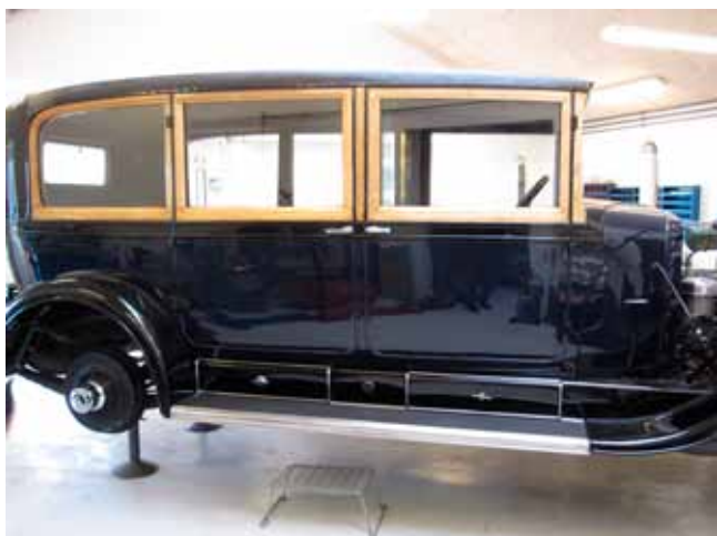
Bilen set fra højre. Læg mærke til de to kasselåg med håndtag i sideskørterne. Der er tilsvarende 2 kasser med låg på venstre side. En sandblæst kasse ses her. Den er klar til reparation og lakering.
