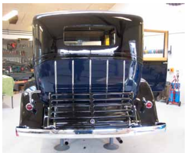
Bagenden af bilen er færdigmonteret med baglygter, kofanger og bagagebærer. Læg mærke til det runde emaljeskilt V12.
