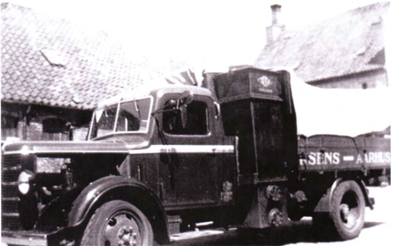
Under krigen blev ruten holdt i gang med en 1939 Bedford udstyret med gasgenerator, bemærk det kvadratiske tværsnit. Motorhjelmens sider var afmonteret for at sikre bedre køling af motoren.
