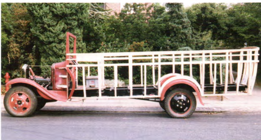
Det komplette asketræsskelet, bemærk de 3 mm galvaniserede forstærkninger til U-80 jernene.
