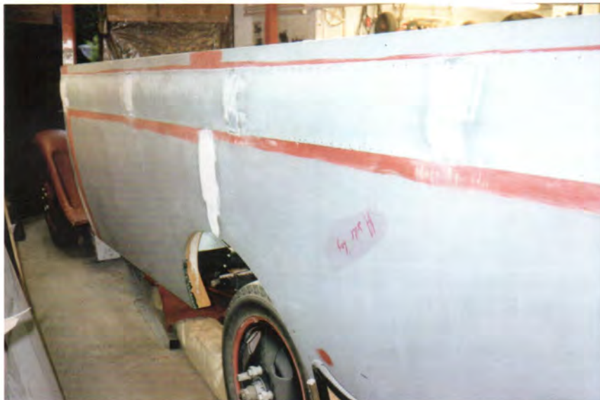
Færdig til lakering - mere spartel var der ikke behov for.
