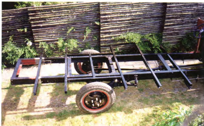
Chassiset med de monterede U-80 jern. Læg mærke til forlængelsen af rammen bagud.
