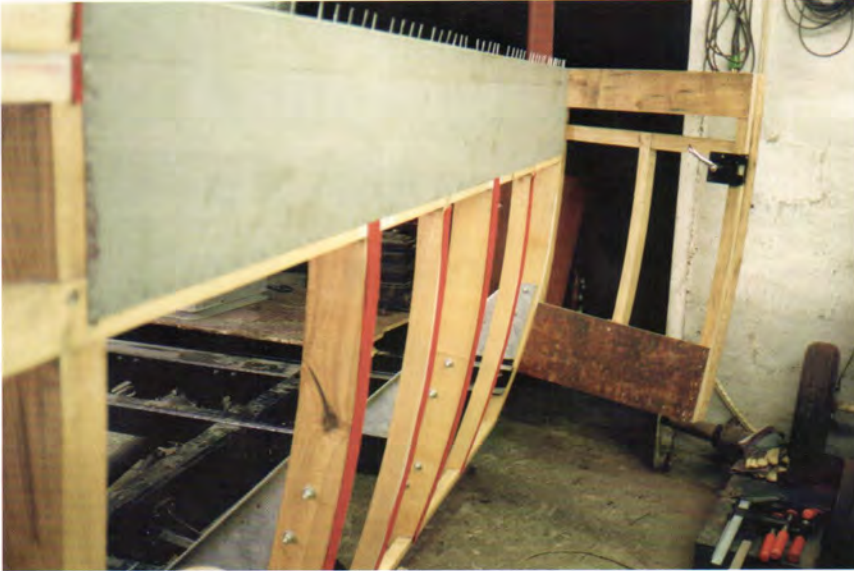
0,9 mm plade sømmes på skelettet. Filt på træ hvor der ikke sømmes.
