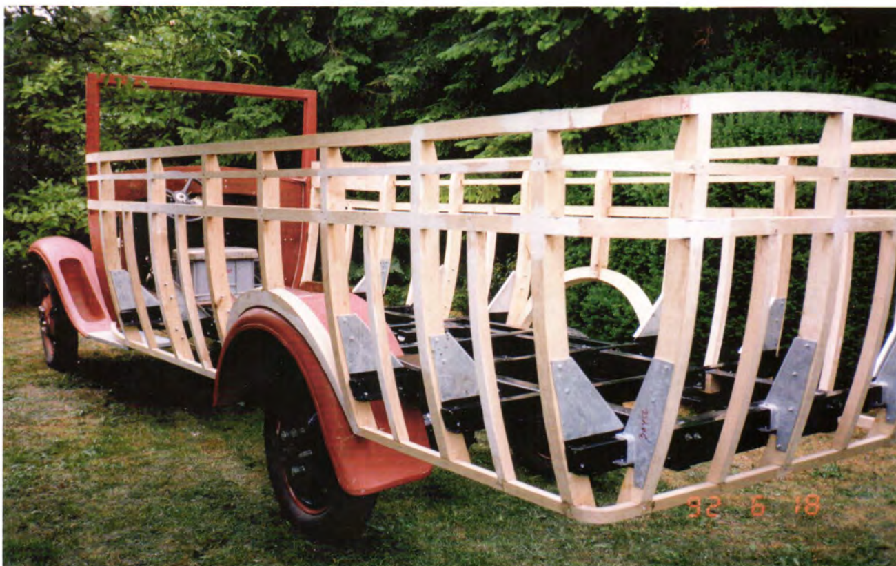
Det komplette asketræsskelet, bemærk de 3 mm galvaniserede forstærkninger til U-80 jernene.
