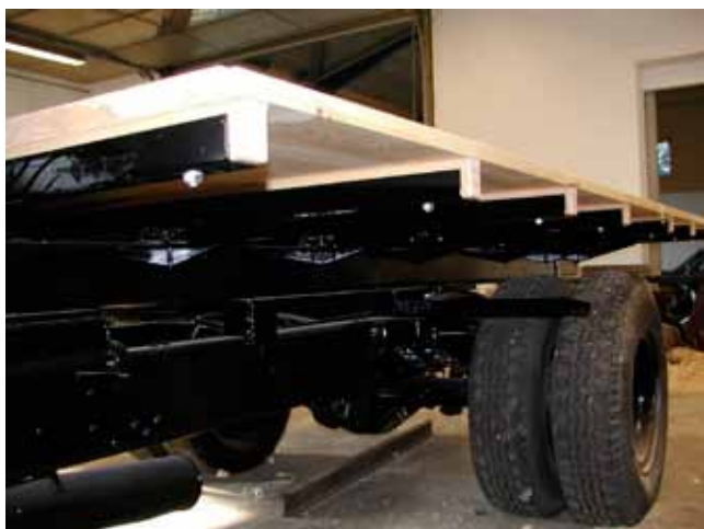
Ladbunden består af 35 x 150 mm brædder af fyrretræ, som sømmes til bøjelægterne med 3" søm.
