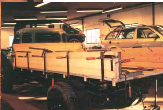
Ladsiden er klar til montage. De specielt fremstillede hængsler af 8 x 40 mm fladstål er fastholdt i rette afstand og i vinkel. Mellem ladbund og ladsidekant er indlagt er træklods, der sikrer frigang ved ladsidens åbning og lukning. Hængslerne monteres med 8 mm bræddebolte.
