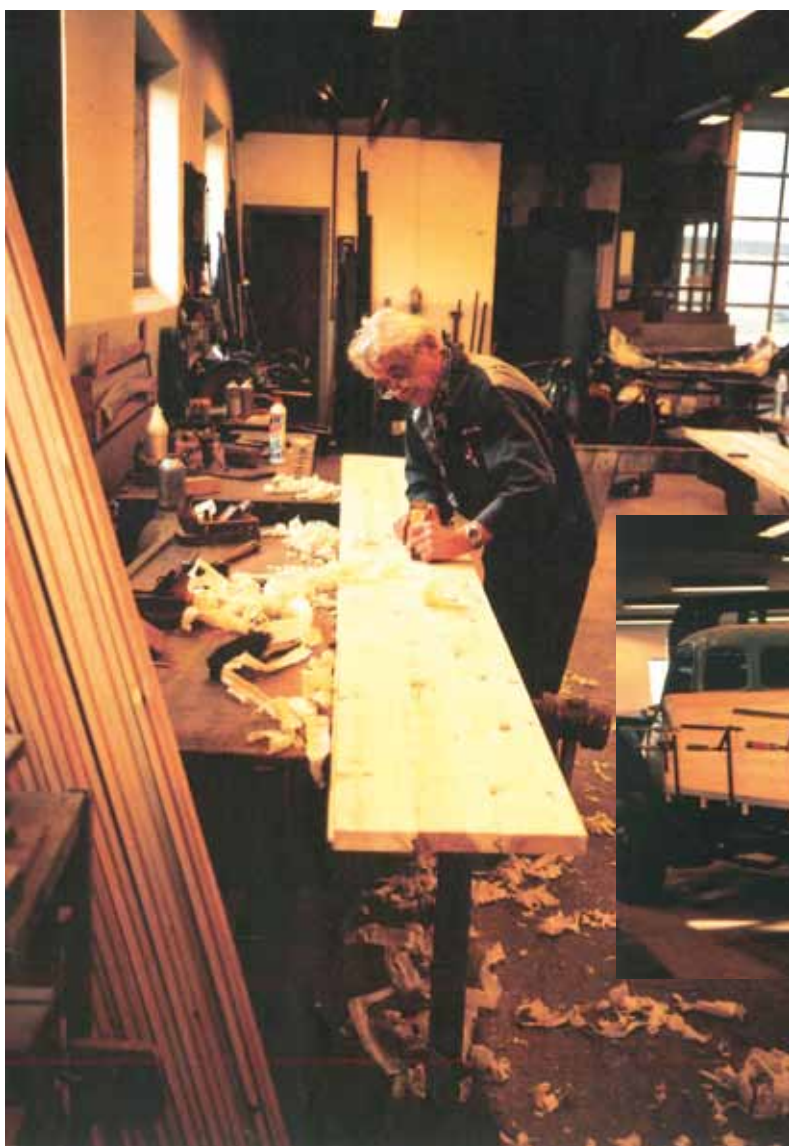
Ladsiderne er fremstillet af høvlede og pløjede fyrretræsbrædder, der limes med vandfast lim. Efter limningen pudshøvles. De krøllede høvlspåner vidner om en perfekt slebet pudshøvl.
