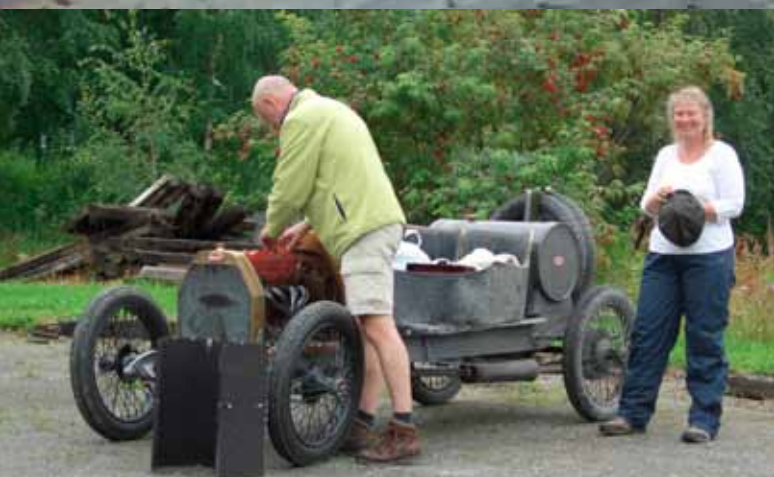
Dendersmørgodtkørgodt: Claude Teisen-Simony skruer smørelågene af Bugatti motoren, så knastaks- len kan få noget olie. Bugattien fra 1912 var med første dag; men den gik ikke rigtig som den skulle. Det eneste elektriske på vognen er mag- net, tændkabler og -rør; men det er nok tændkablerne, den er gal med. Fru Vibeke ser tilfreds ud; men de er også nået frem til lunchen, og grus og ler fra vejen er vasket af.
