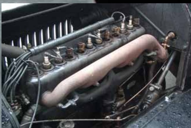
Studebakerens motor minus benzinrøret, som blev blæst rent. Det viste sig nu at være vand i strømfordeleren, der var årsagen til at den ikke gik.
