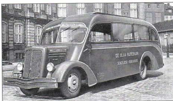
A 16.131 Et fint formet rutebilskarrosseri til 23 passagerer, strammet op med forkromet kofanger og lister. Fotograferet på Amalienborg Slotsplads. Under den perforerede plade, der danner frontlukke, skimtes motoren. Den manglende køler indikerer at der er tale om den luftkølede dieselmotor af boxertypen. Det forklarer også det højt placerede startsvinhjul. Til håndstart må der have været en aflastningsventil, normalt kan man ikke trække en diesel over kompressionslaget. Til rensning af frontruden er der monteret 4 (!) viskere, normalt måtte man nøjes med een.
