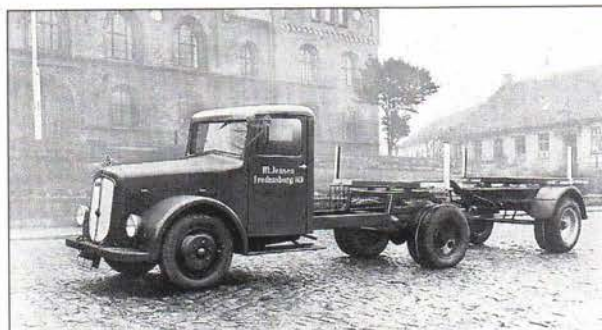
B. 10.090 En langtømmervogn med orden i drejgeometrien, i modsætning til langtransport med drejeskamlar på forvognslad og påhængsvognslad. Lastevne 6,5 tons.
