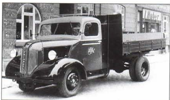
Triangel 1941 med lad der svarer til den kalkulerede størrelse. Generatoren blev monteret i højre eller venstre side, på lastbiler til langtransport af tømmer eller stålbjælker blev den placeret bag i ladet mellem chassisvangerne. Generatorbrændet opbevarede man i sække på førerhuset.
