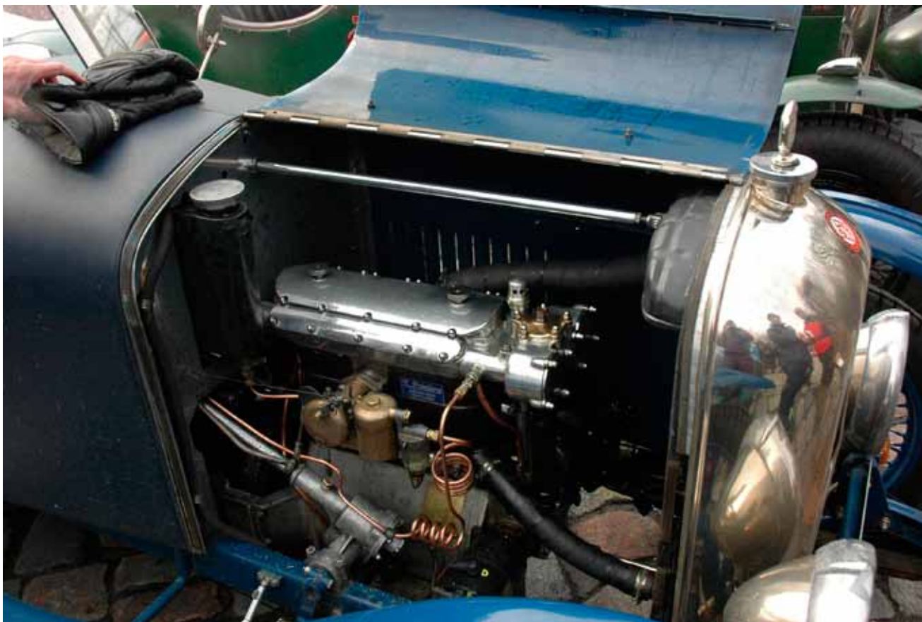
Motor i Salmson GS. 4-cylindret motor med 2 overliggende knastaksler i ualmindelig lækkert design.
