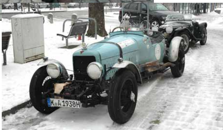
Alvis. Model og årgang ukendt, men den er fra engang i trediverne. Har kompressor, som er dækket af isolering med tagpap, for at holde kulden ude.
