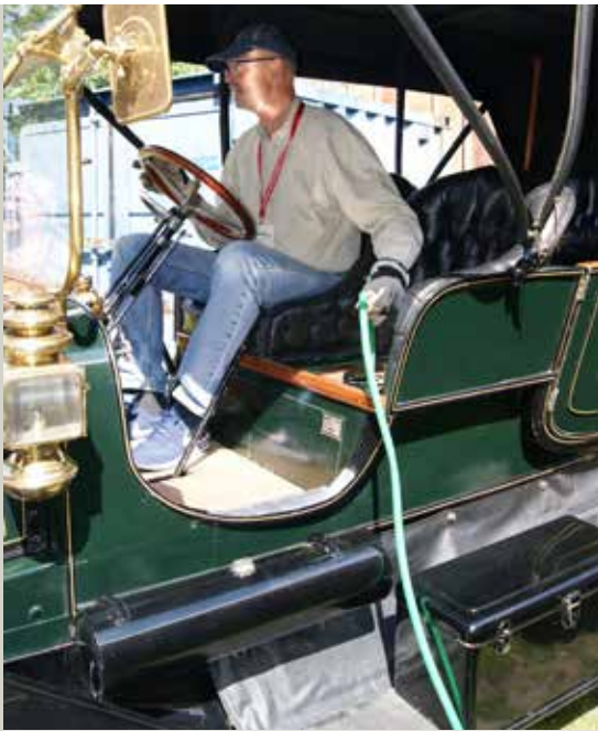
Per Nielsen tanker vand på Stanley'en – efter hjemkomsten lettes trykket på kedlen. Godt at stå i behøring afstand.
