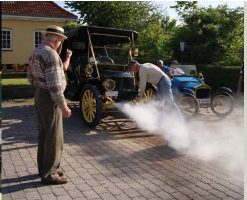
Per Nielsen tanker vand på Stanley'en – efter hjemkomsten lettes trykket på kedlen. Godt at stå i behøring afstand.
