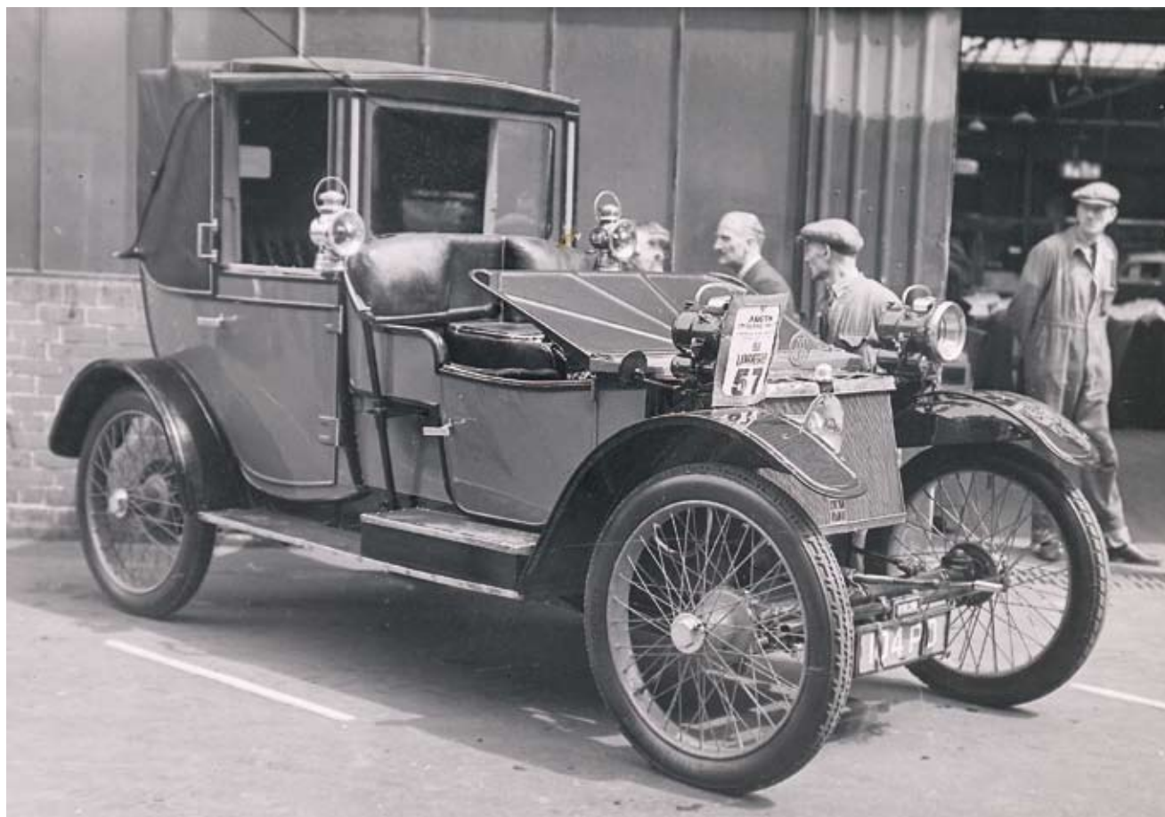
Også den særprægede Lanchester var i Danmark – med dateringsskilt fra VCC. Styringen foregår med en stang til højre, langs vognsiden og førerens underarm.
