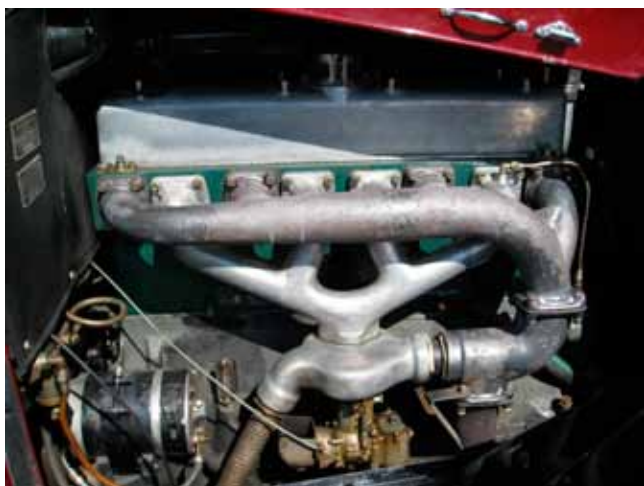
Manifoldsystem med forvarmer til karburator.
