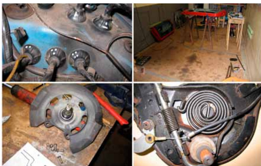
Under demonteringen mærkes alt minutøst, og der fotograferes, så alt kan genmonteres som oprindeligt. Instrumenter og en del ledninger genmonteret efter renoivering.
