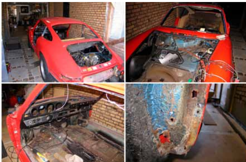
Ruder, døre og klapper er afmonteret. Alle elektriske ledninger og varmeanlæg er afmonteret. Sæder og instrumenter ligeledes - kort sagt total afmontering. Hullet i og ved venstre forsærm var det eneste rust i karosseriet.
