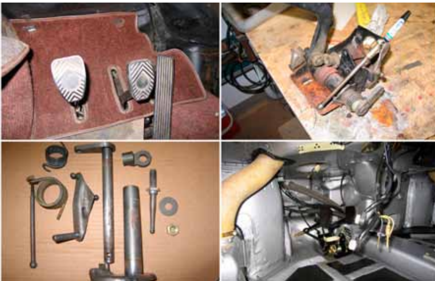
Pedaleriet før, under renovering, og efter genmontering. Bunden af karosseriet under pedalerne plejer at være hårdt rustangrebet, her var det som nyt.
