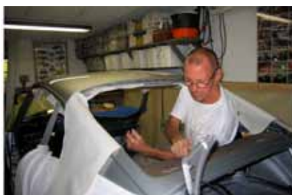
Endelig på vej til autolakerer. Der afdækkes, slibes, grundes og lakeres i den originale Porsche farve, "Silver Metallic nr. 936". Hjemkommet og klar til slutmontering. Porschen er noget højbenet på grund af den manglende motor.
