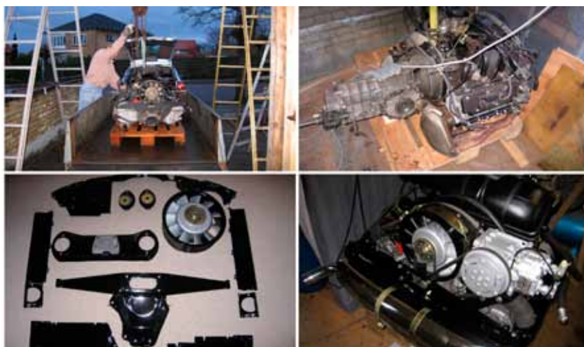
Motoren er taget ud og opmagasineres indtil videre. Så mange komponenter som muligt afmonteres af motoren og renoveres enkeltvis. Igen klar til montering. Der er justeret ventiler, udskiftet dyser, slanger og pakninger og i øvrigt kun foretaget kosmetiske indgreb.
