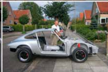
Endelig på vej til autolakerer. Der afdækkes, slibes, grundes og lakeres i den originale Porsche farve, "Silver Metallic nr. 936". Hjemkommet og klar til slutmontering. Porschen er noget højbenet på grund af den manglende motor.
