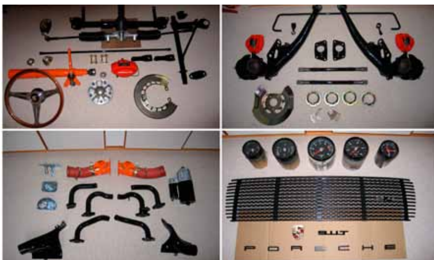
Så mange dele som muligt adskilles og renoveres enkeltvis. Alle beslag cadmieres på ny i de rigtige nuancer. Det er en fornøjelse at se de færdige delresultater.
