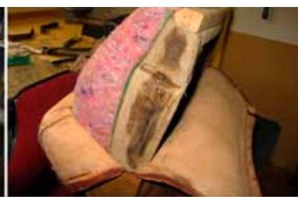
Nu bliver det spændene igen. Der monteres ny himmel, syes og monteres nye måtter og monteres nyt læder i kabinen.
