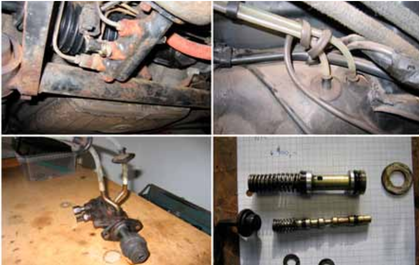
Efter afmontering af dækpladen, der beskytter bremsecylinder og styretøj, fremstår alle dele næsten som nye. Alt fotografæres, opmåles, adskilles og gennemgås i mindste detalje.
