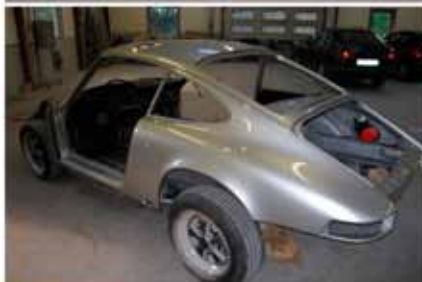
Endelig på vej til autolakerer. Der afdækkes, slibes, grundes og lakeres i den originale Porsche farve, "Silver Metallic nr. 936". Hjemkommet og klar til slutmontering. Porschen er noget højbenet på grund af den manglende motor.
