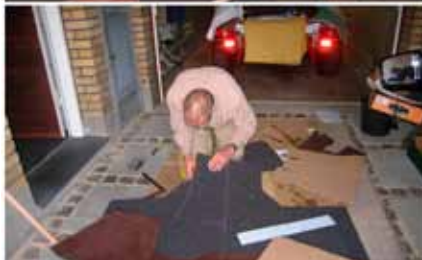
Sæder strammes op, og sadelmager forsyner dem ned nyindkøbt læder. Måtter fremstilles dels efter de gamle måtter og dels efter nye skabeloner. Den færdige kabine.
