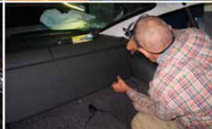
Nu bliver det spændene igen. Der monteres ny himmel, syes og monteres nye måtter og monteres nyt læder i kabinen.
