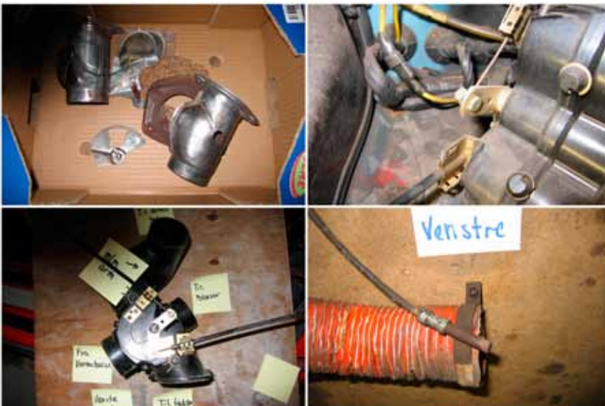
Defrosteranlægget, som på en luftkølet Porsche kan synes en smule primitivt, adskilles fuldstændigt. Der fremstilles nye pakninger og tætninger overalt. Kabler smøres.
