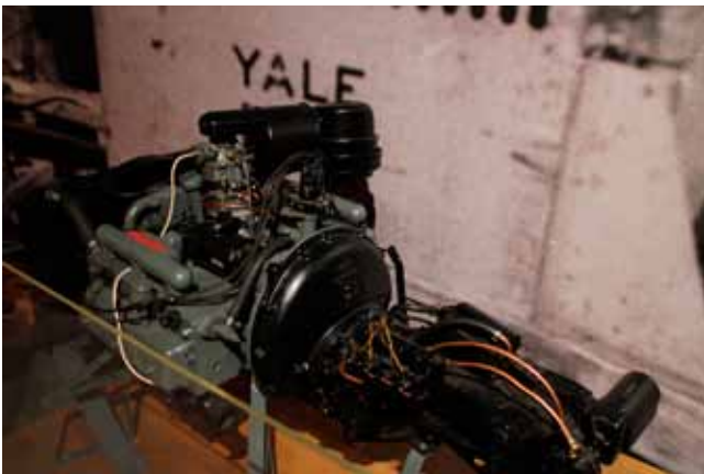
Helikopter motor med Cord gearkasse fra Tucker nr. 1018.
