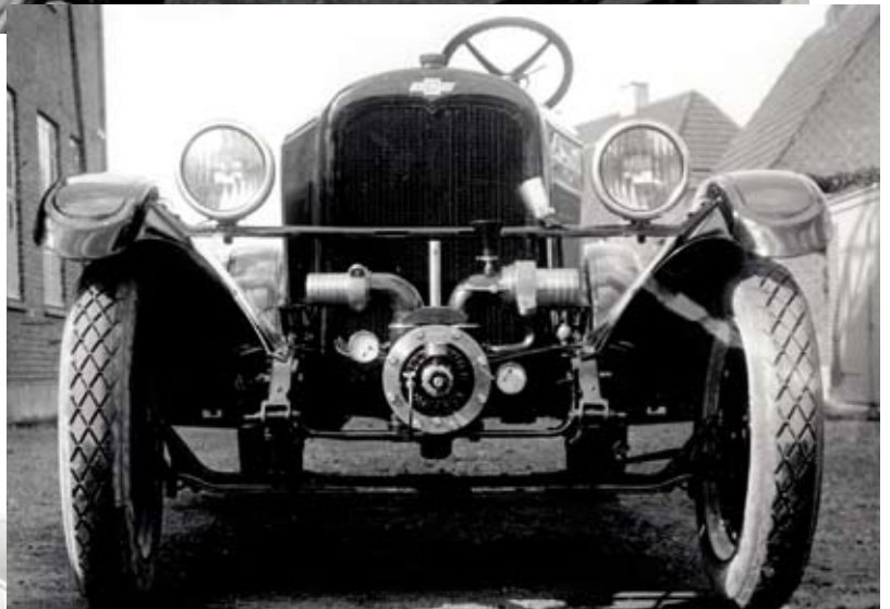
Den helt rigtige opfindelse var da Ellehammer satte brandpumpen direkte på bilmotoren. Her en Chevrolet 1927 og en tidlig Ford A.
