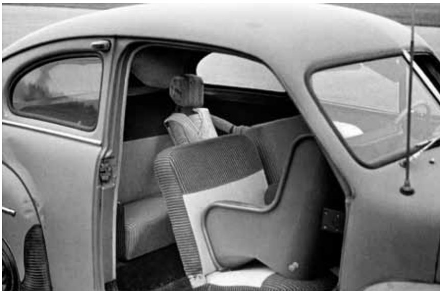
I 1964 gennemførte Volvo sine første forsøg med en bagudvendt barnestol i en af sine PV544-modeller.
