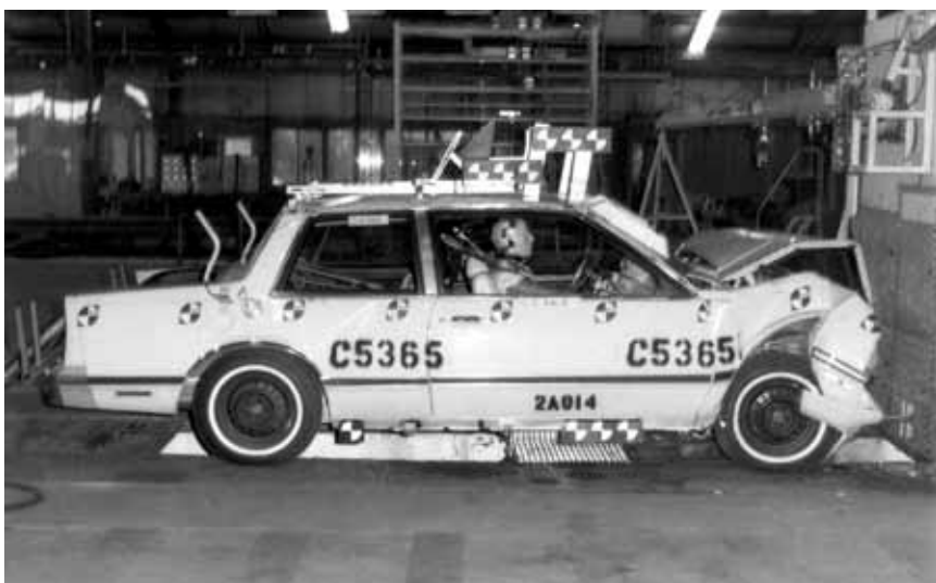
I 1982 har kollisionstesterne nået den systematik, som også kendes i dag: de kombinerede runde og kvadratiske sidemarkeringer, der før testen er placeret meget nøjagtigt i forhold til hinanden, så man bagefter kan måle deformationerne.
