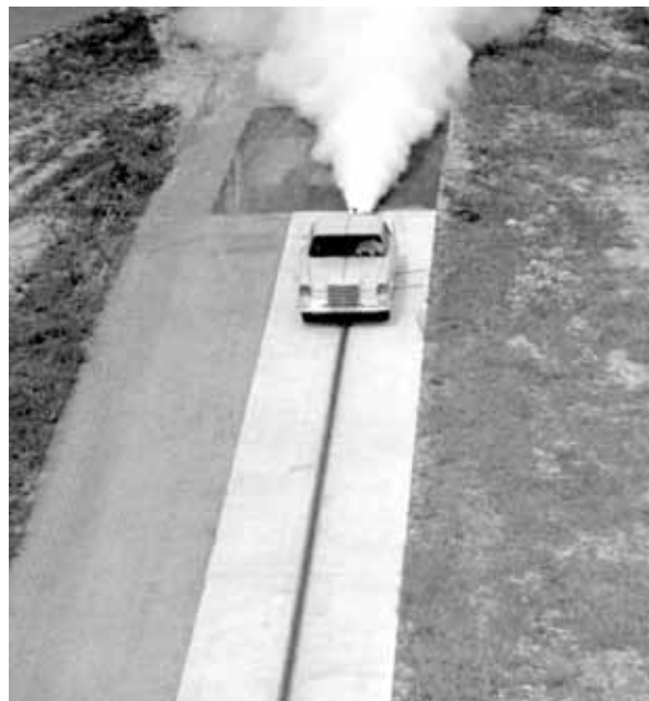
Det gik bogstaveligt for fuld damp, da Mercedes i begyndelsen af tresserne går over til at anvende et dampdrevet, raketlignende køretøj til at skubbe forsøgs køretøjerne frem mod den hårde forhindring.
