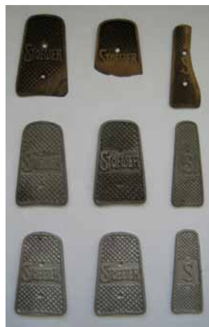
Stoe- werens pedalplader. Øverst de originale, der mere end antyder at bilen har været brugt flittigt. I midten ses fars Blyafstøbninger, og nederst de aluminiums-afstøbninger som støberiet fejlagtigt lavede.
