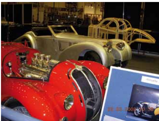
Nybygget Bugatti T 57 + træstel også for T 57 samt Alfa sportsvognsprojekt, nybygget.
