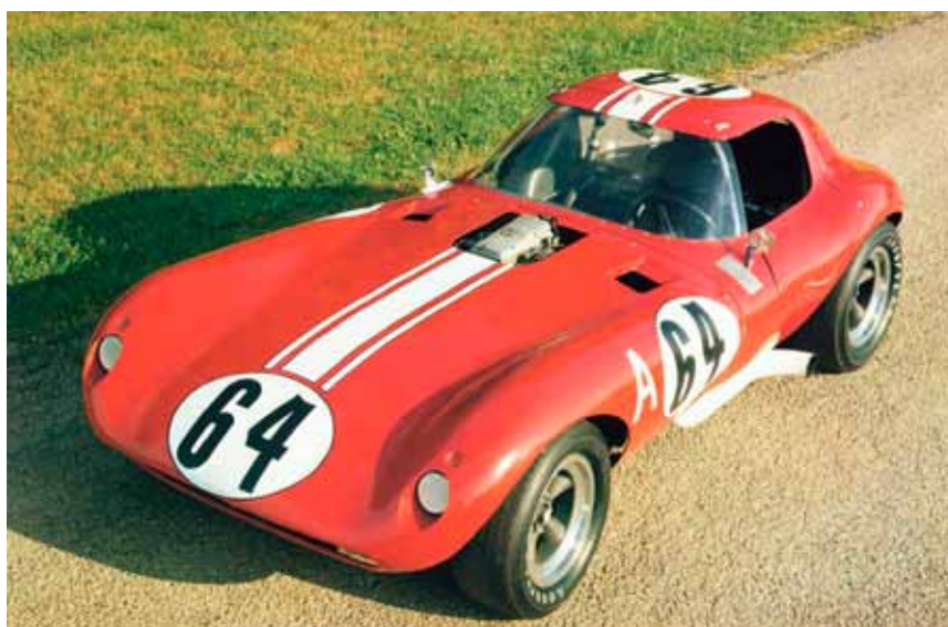
Et restaureret pragteksemplar på udstilling i 2004. Her ses tydeligt, hvorledes plexiglas forruden kun er fæstnet til taget og torpedoen.
