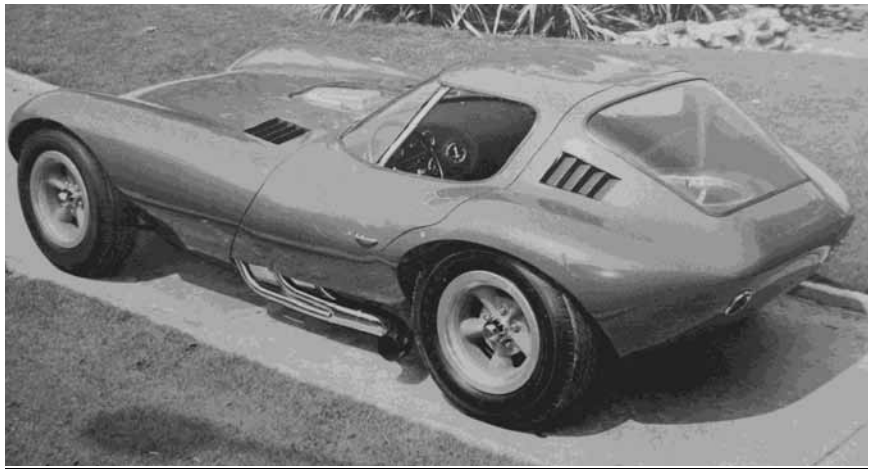
En af de første prototyper beregnet til gadebrug og præsentationsbil for GM's ledelse. Bemærk at der er ingen "A-Sprosse", det er styrtbøjlen man kan se; og forruden har ingen fast afslutning.
