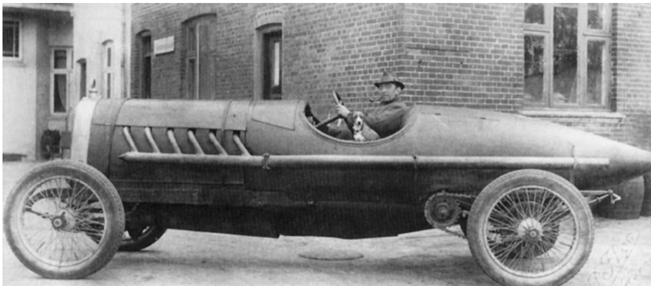
Det kan nok være at vognmanden fra Herning vakte opsigt på hjemmebane, når han i stille aftener prøvekørte Overdynen, den tids Il Tempo Gigante, på landevejen mod Holstebro. Den blev rigget til med aerodynamisk bagende – fronten var der ingen der rigtig tænkte på - og med et vældigt udstødningsrør fra den 10 liters Mercedes-motor. Hans Dynesen har udstyret sig med blød hat, pibe og sin elskede hund, når han alligevel skulle til fotografen. Foto: Lokalhitorisk Arkiv, Herning.
