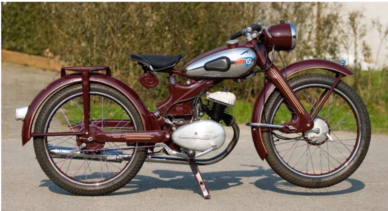
NSU Fox 2-takter 125 ccm 1953. Bemærk hos Fox, at der er fingerskruer ved forreste svingarme til regulering af stramhed.
