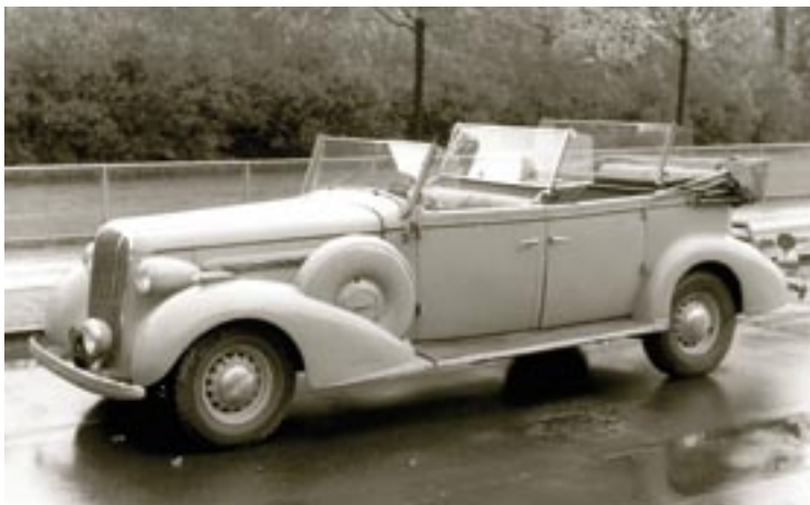
I 1936 lavede Bülow på bestilling et monster af en 9-personers åben Buick. Da Buick ikke kunne levere et bart L-90 chassis måtte en limousine ofres. Det siges at køretøjet i dag går som hotelbil i Irland.
