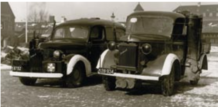
Under krigen monterede Bülow utallige Imbert gasgeneratorer, på billedet fra 1944 er det endog på en Chevrolet ambulance og en Bedford kranbil fra Falck.
