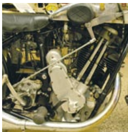
BSA Sloop med den karakteristiske skrå cylinder.
