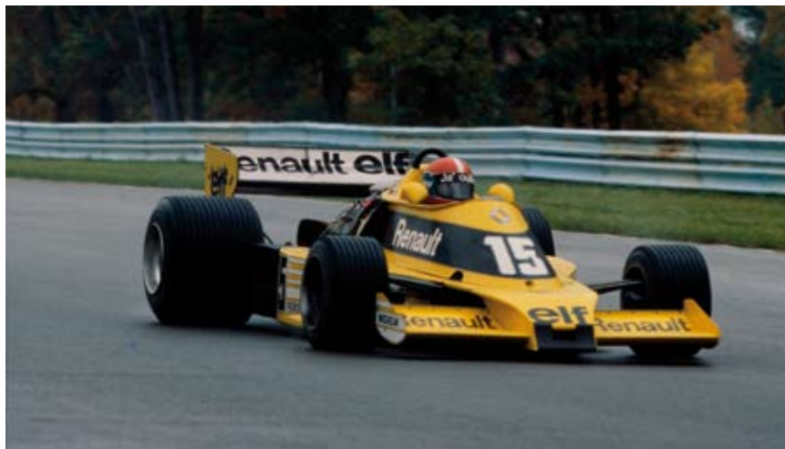
Siden 1966 havde reglementet givet mulighed for at stille op med en 1,5 liters motor med turbo, men ingen havde gjort det. Indtil Renault i 1977 atter dukkede op i sporten og satte gang i en hestekraftsspiral, som først stoppede ved 1.300 hestekræfter. (Renault)
