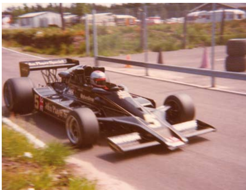
Med Lotus 78-modellen revolutionerede Colin Chapman atter Grand Prix-sporten. Med en underside udformet som en vinge havde bilen langt mere downforce end nogen anden Grand Prix-racer indtil da. (Henrik Kirkegaard)
