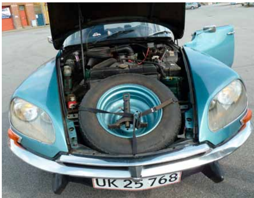
Reservehjulet er placeret under fronthjelm, så luftindtag til køleren sker under bilen.
