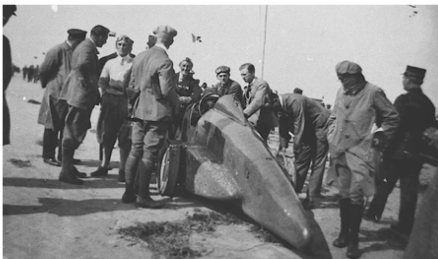
Lørdag den 23. August 1924 på Fanø Strand: Blue Bird'en har mistet sine vulst-dæk på begge baghjul. Intet dæk havde nogensinde før kørt så hurtigt.
