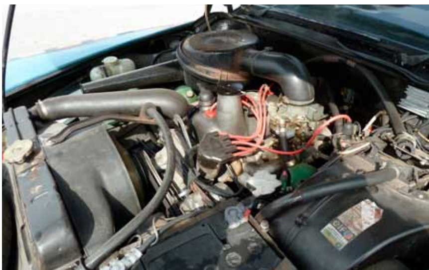
Motorrummet med køleren bag reservhjulet.
