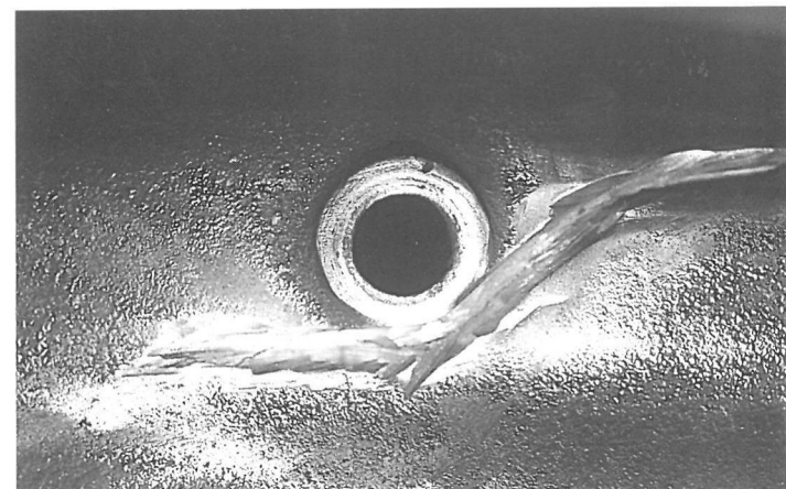
Topstykket er rengjort og en V-formet fuge slebet ved revnen.
