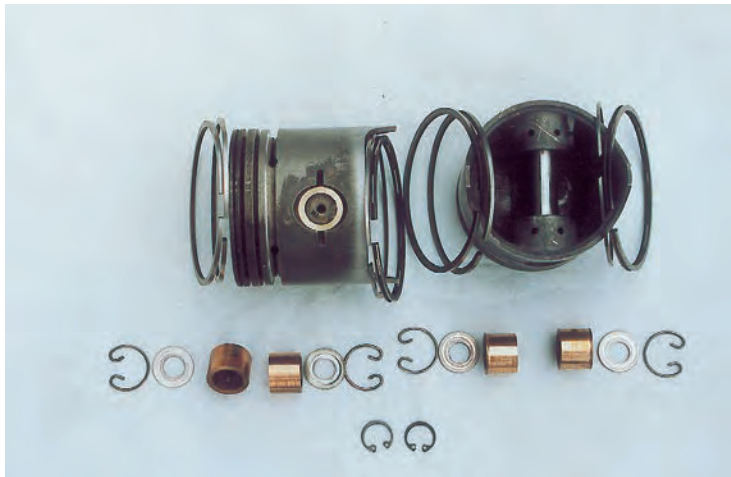
Her ses de udskiftede bøsninger, spændeskiver og låseringe linet op foran stemplerne. De to små låseringe forrest i billedet er de nye der er anvendt. Man kan på billedet godt se en anbragt på plads i det venstre stempel.
