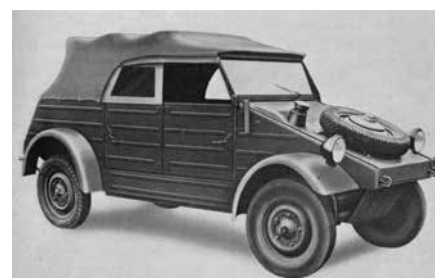
Fabriksfoto af VW Kübelwagen Typ 82. Bemærk benzinpåfyldningsstutsen, som ikke krævede tragt, ved påfyldning fra 20 liter Kanister (Jerrycan). Werner Oswald: Kraftfahrzeuge und Panzer der Reichswehr.
