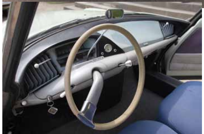
Kølevandstermometret og de to kontrollamper for blinklys er standardudstyr, monteret hos Citroën i Danmark.
