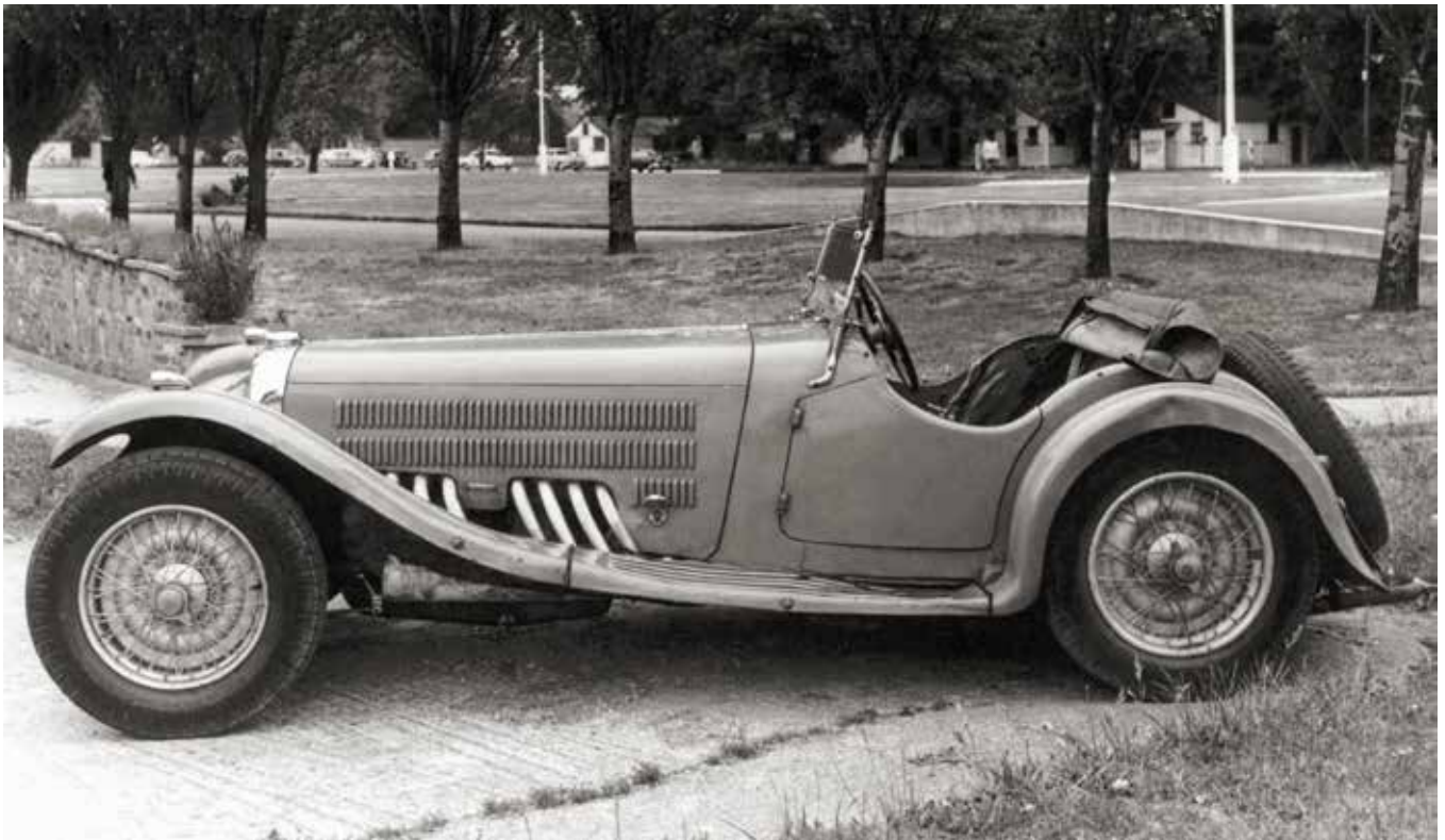
Fotografiet fra Geoff Goddard Collection viser den anden vogn, som HSM byggede af udstillingschassiset DMH2 - med motoren længere tilbage, med Corsica-karosseri og med en anderledes køler. Den er senere blevet ombygget til 'normalt' Dolomite-udseende for sydafrikaneren David Cohen.
