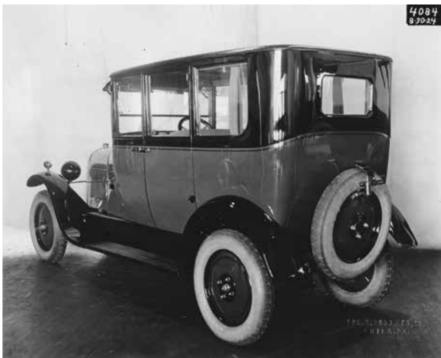
Citroën B10 Conduite Interieure. Men læg lige mærke til stemplerne på billederne. Her er nemlig en Citroën der næsten helt sikkert er lavet i USA! De sensationelle billeder er fundet i Budds arkiver i Philadelphia og bilen er en pre-serievogn. Forskærmene er ikke som på de senere produktionsmodeller, men ligner dem, der kom på B12 et år senere.
