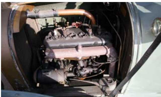
Motoren har fast top. Der er propper til huller man kan fiske ventilerne op fra.
