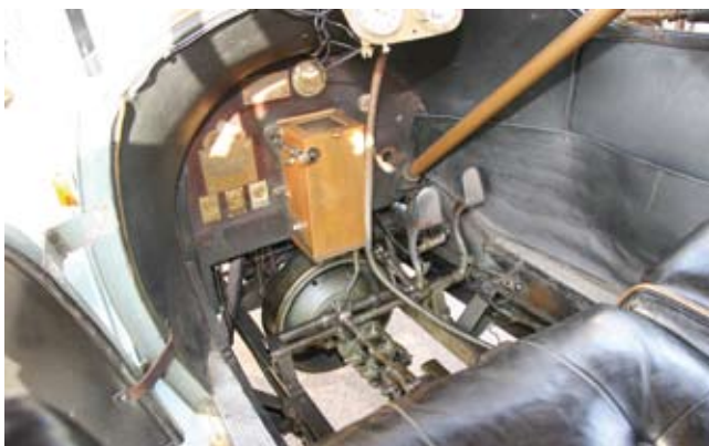
Muddermaskinen til smøring. Man hælder motorolie i kassen, skovlene drives af en aksel, der går ud i motorrummet og trækkes rundt af en rem. Man ser en af skovlene i øverste position. De tømmer sig i en lille tragt, hvorfra olien løber gennem rør til hovedlejer mm. På en af skovlene er en lille ekstra, der leverer et dryp til gearkassen.
