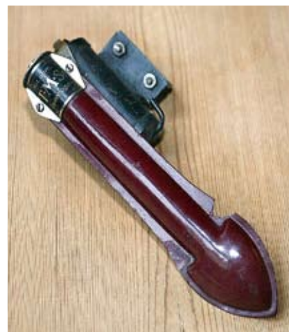
Et eksemplar af den vacuumdrevne retningsviser, Niels Madsen tog patent på.
