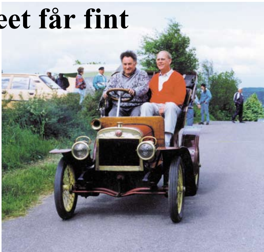
L&K voiturette, 1905. Den første bil fra det der blev til Skoda. Bemærk at hjulene er motorcykelhjul med jerneger. Den endelige version kom med fælge i træ.
