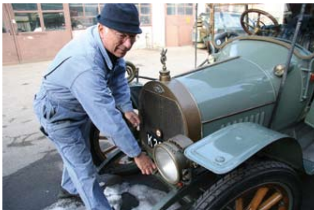
På den højre lygtebøjle sidder et håndtag, man kan støtte venstre hånd på når man drejer håndsvinget med højre.
