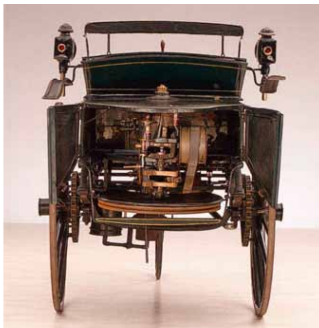
Motorrum hvor det vandrette (start)svinghjul ses.
