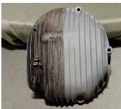
Topstykke før og efter behandling.
