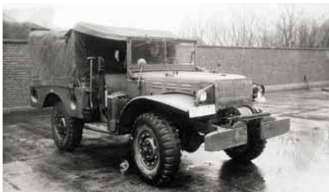
Dodge WC52 USA, et populært køretøj, der i dag findes i stort tal blandt samlere. Denne Dodge har et spil monteret mellem forvangerne, dette gjorde i sin tid, at der krævedes stort førerbevis til at køre den. Dodge WC51, som ingen spil havde, kunne køres på lille førerbevis (under 2500 kg). WC står for "Weapons Carrier".
