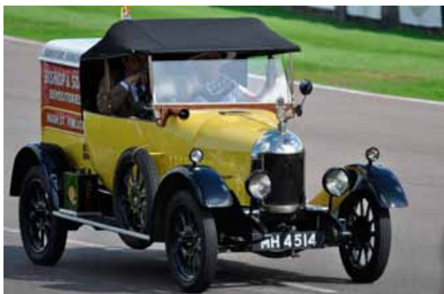
Morris Cowley Commercial 1924. Mere end 150.000 person- og erhvervsvogne produceredes 1919 til 1926. 1802 ccm motoren fra 1923 brændte varm og køler og 'tyrenæse' blev gjort større og kantet.
