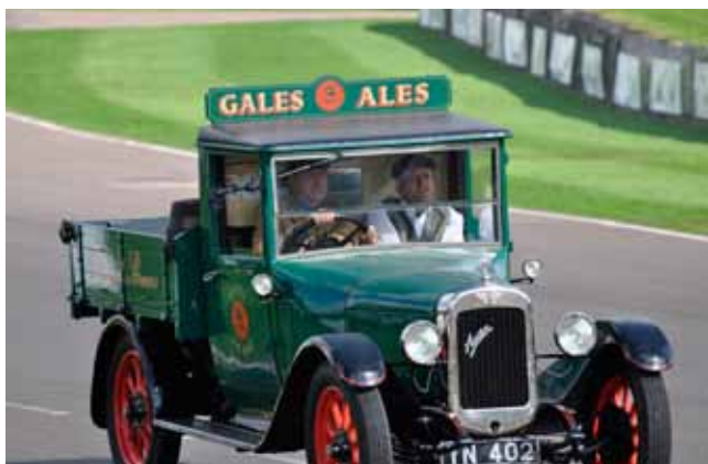
Austin 12/4 1928 som ølvogn fra Gales bryggeri. Austin Twelve Four var populær både som person-, vare- og lille lastvogn. Denne størrelse produceredes fra 1922 til 1939 og havde en firecylindret sideventilet motor på 1660 ccm som leverede 20 heste.
