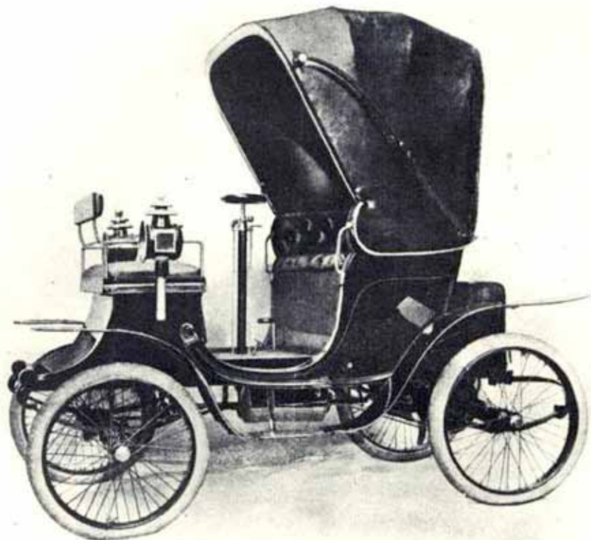
Med kalechen slået op var vognen ret følsom over for modvind. Aerodynamik var tilsyneladende et uudforsket område for automobilbyggerne dengang.
