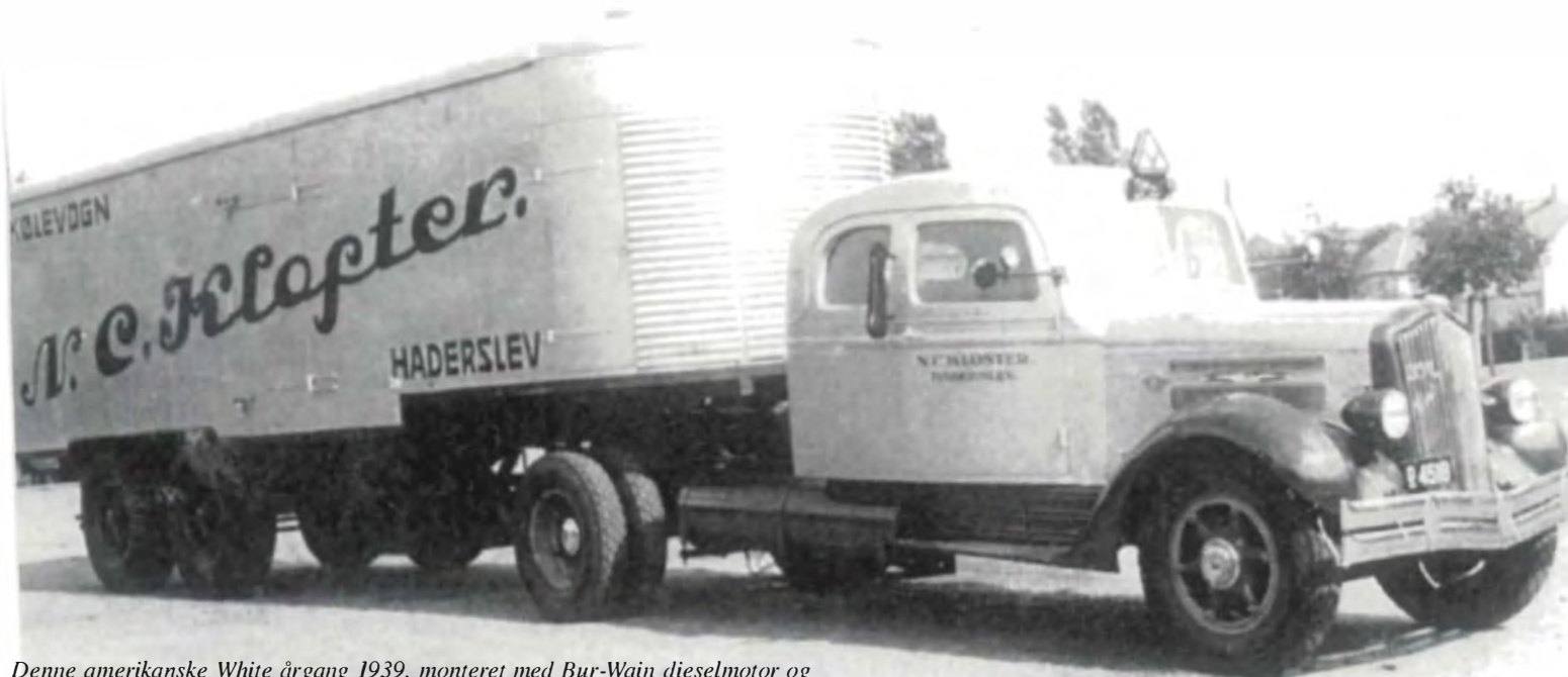
Denne amerikanske White årgang 1939, monteret med Bur-Wain dieselmotor og danskbygget førerhus med soveplads, repræsenterer det bedste for sin tid. Sættevognen er formentlig også dansk fra DAPA i Åbenrå. De store amerikanske lastbiler var typisk monteret med støbte artillerihjul og store forkromede navkapsler. Den dobbelte forkromede kofanger understreger bilens farver, røde skærme og undervogn med sølvfarvet karrosseri. Se iøvrigt Christian Juels artikel om Bur-Wain Autodiesel A/S 1938-48 i Bihistorisk Tidsskrift nr. 72.
