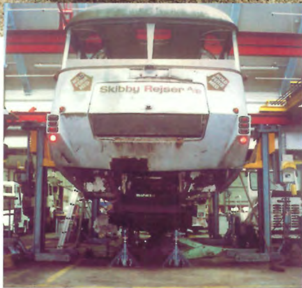
Ramme for sig og karrøse for sig, billedet giver tydeligt indtryk af de pladsmæssige forhold der er nødvendige til en total restaurering af en bus.
