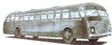
DOMI bybuskarosseriet på et VOLVO chassis. I dette billede viser illustrationen af DOMI karosseriet, der er indrettet som bybus med plads til 60 personer.
