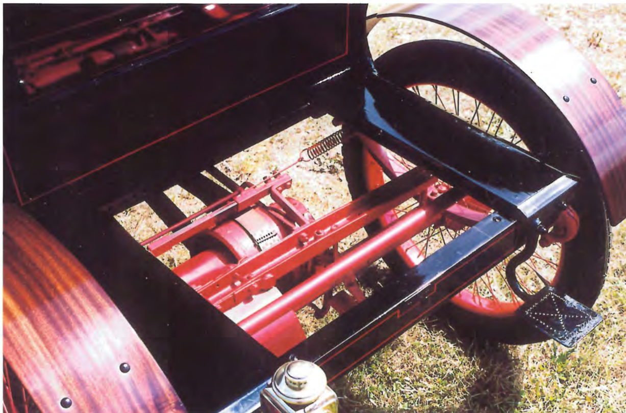
Louring har valgt ikke at genskabe tjenersædet bagest – det ser så fjollet ud. Man ser håndbremsen på bagakslen. (Farvefotografierne er taget af Hanne Louring).
