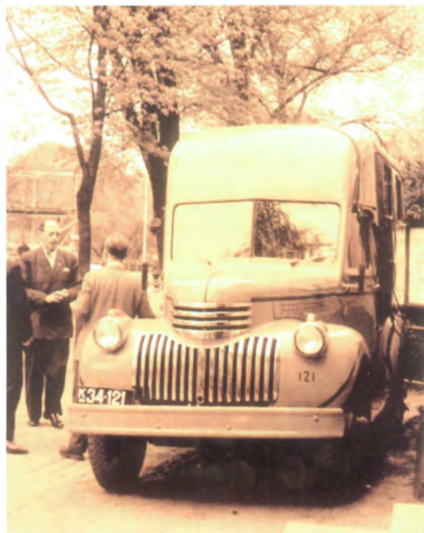
Ved Dronning Elizabeths statsbesøg i maj 1957 fungerede igen en udrangeret postbil som reportagevogn. Man kunne stå op og betjene apparaterne. Det er en Chevrolet 1946 – sammen med Forðs amerikanske V8-lastvogne vakte de umådelig opsigt herhjemme, Chevrolet'erne dog også fordi de efter den tids målestok var fuldstændig lydløse. Chevrolet havde lanceret grinet i 1942, men det så vi jo ikke noget til.
