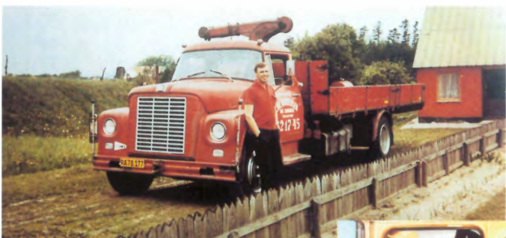
Efter B modellen kom Loadstar 1600 og 1700. Dem samlede vi med både D-6-354 dieselmotorer og V8 benzinmotorer. Her var motorhjelmen todelt i sideklapper. Loadstar'en på fotoet er en 1600 udstyret med en D-6-354 dieselmotor.
