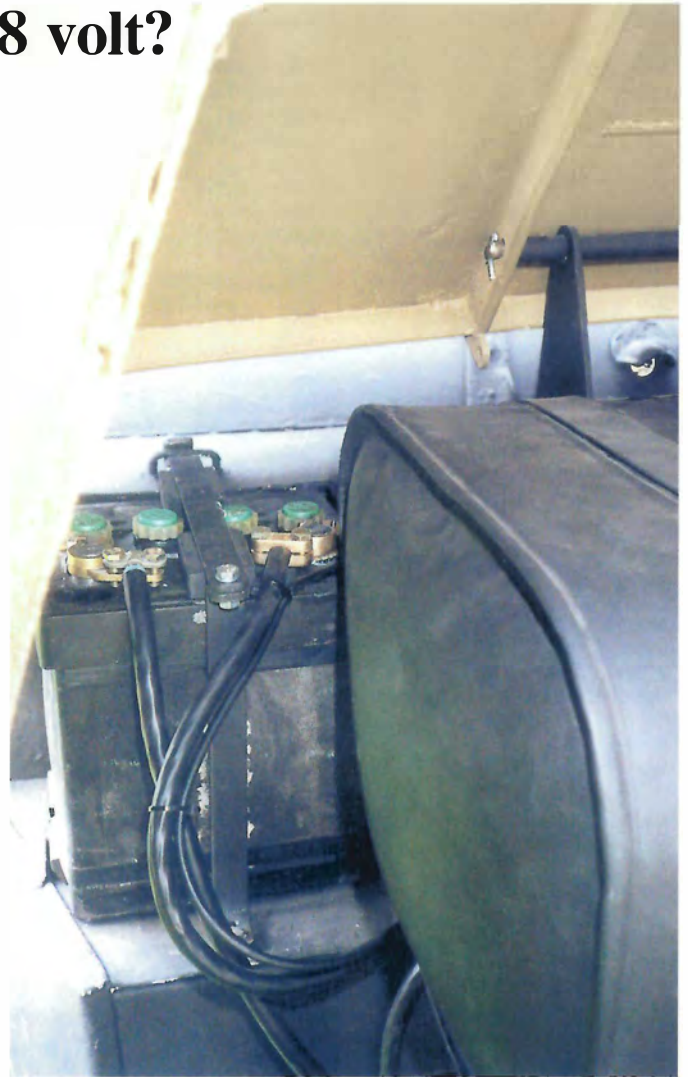
Usædvanligt, men måske har det sine fordele: et batteri med 4 celler à 2 volt giver 8 volt.
