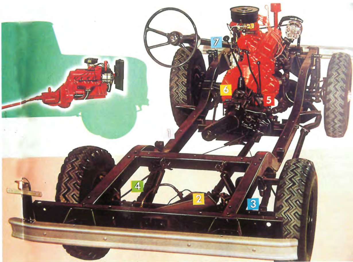
Her ses opbygningen af et Scout-80 chassis med undervogn, motor og transmission. Der kan ligeledes leveres forskellige kraftudtag så den eksempelvis kan udstyres med en frontmonteret fejekost eller et på bagenden monteret jordbor.
