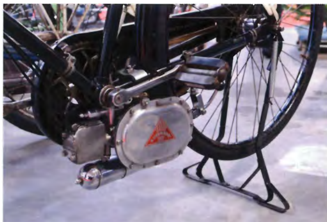
Der er plads til mange specialiteter på knallertudstillingen i Herning. Her en tysk Lohmann krankmotor i nærbillede. Den udmærker sig ved utrolig driftsøkonomi, idet der er tale om en 18 cc. dieselmotor.
