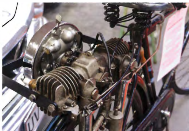
Johnson-familien i USA – af dansk afstamning - producerede Johnson Motorwheel, hvor en 2-takts boxermotor udviklet fra en båd-motor kunne sende en almindelig cykel op på 50 km/t.
