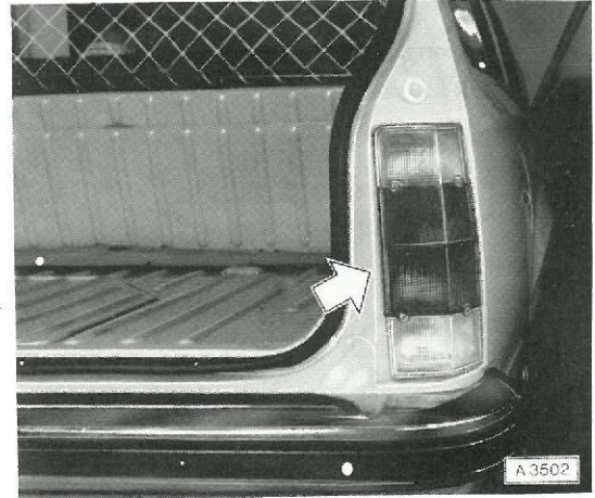
2. Baglygtehus fladere udformet.
