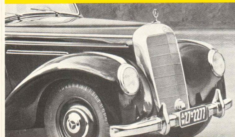
Die Synthese von Fortschritt und Tradition zeigt auch die Frontansicht dieses Wagens. Das markante Mercedes-Benz-Kühlergesicht ist geblieben. Die Scheinwerfer sind in die Kotflügel eingebaut. Die Motorhaube läßt sich nach hinten hochklappen und ist besonders gesichert.
