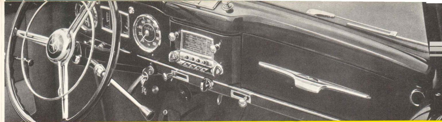
Kaum einen Finger zu rühren braucht der Fahrer in diesem Wagen. Das Lenkrad mit Signalring, der zugleich die Winker, bzw. die Blinklichter der Cabriolets betätigt, die griffgerechte Lenkradschaltung, das Armaturenbrett mit den übersichtlich angeordneten Bedienelementen, der Rückblickspegel mit Ablendeinstellung, alles dient nur dem einen Zweck, den Fahrer zu entlasten und ihm den vollen Genuß der Fahrt zu ermöglichen. Auf Wunsch Radio-Anlage mit automatischer Stationswahl.
