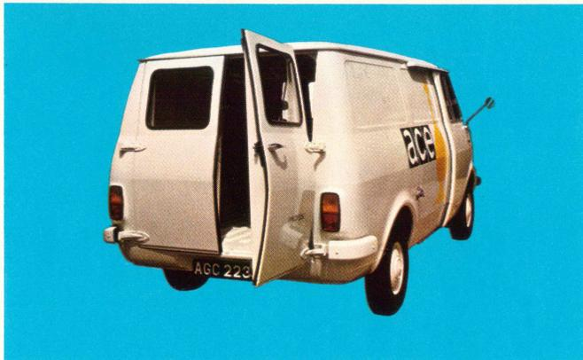
Bedford CF leveres som standardudstyr med to hængslede døre i førerhuset sammen med en meget bred hængslet dør i højre side af varerummet og med dobbelte bagdøre med ruder og med to-trins hængsler til 90° eller 180° åbning. På bestilling kan CF leveres med skydedøre i førerhuset, men uden sidedør i varerummet, og med hængslede døre i førerhuset ligeledes uden sidedør i varerummet.
