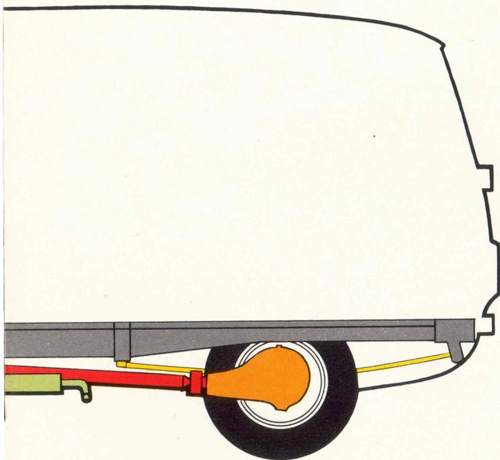
**Forfjedre:** Skruefjedre i forbindelse med dobbelte V-formede tværsvingarme.
